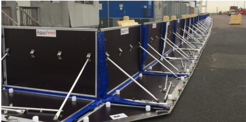
Abbildung 12: Foto eines mobilen Hochwasserschutzes als Klappsystem [U28]
